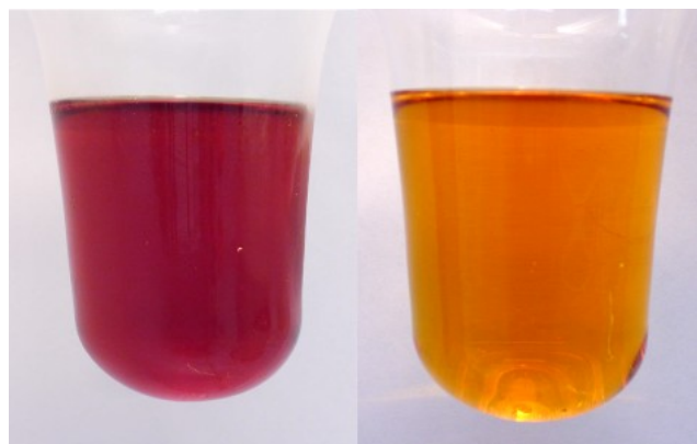
Abb. 3.36. Lösung von [\text{Fe}(\text{NCS})_2(\text{Py}_3\text{CH}_2\text{NMe}_2)] (3.7) in Aceton knapp über dem Gefrierpunkt (links) und bei Raumtemperatur (rechts).
